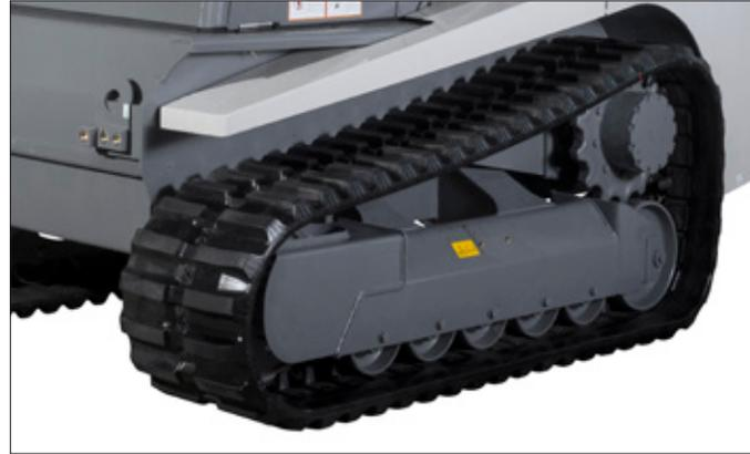
Dos reductores planetarios proporcionan una óptima velocidad de traslación y suficiente fuerza para el uso de accesorios pesados.
