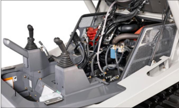
La cabina abatible permite un fácil acceso al motor y a los componentes hidráulicos principales.
