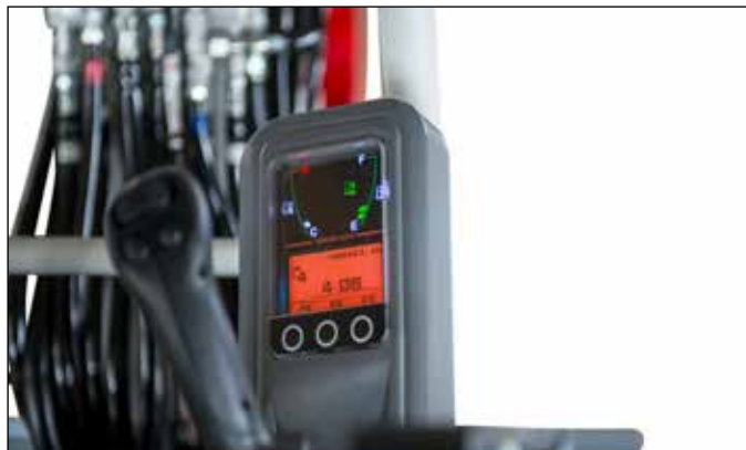
Nuevo display de vidrio laminado resistente a rayaduras, con elementos de monitoreo visual y acústico.
