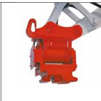
Power tilt con enganche rápido hidráulico
