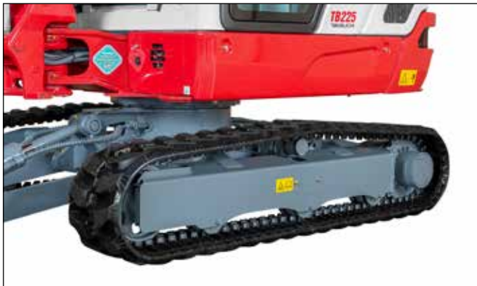
Rodillos con guía interior y exterior para un funcionamiento seguro de las cadenas de goma Double-Short-Pitch que reducen vibraciones.
