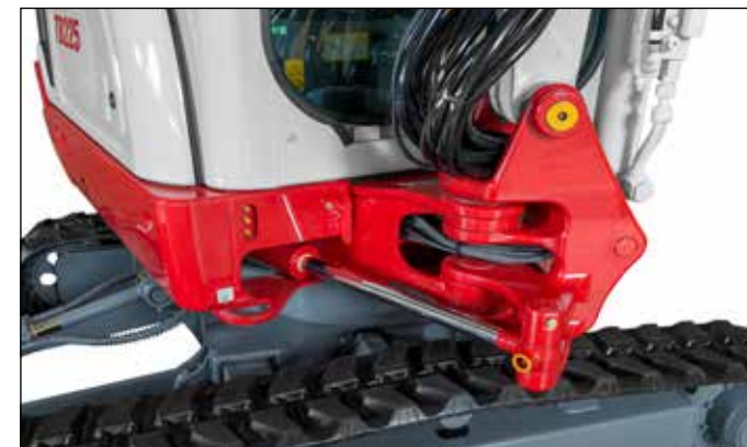
Bloque de giro robusto con cilindro de giro del brazo y latiguillos especialmente protegidos.
