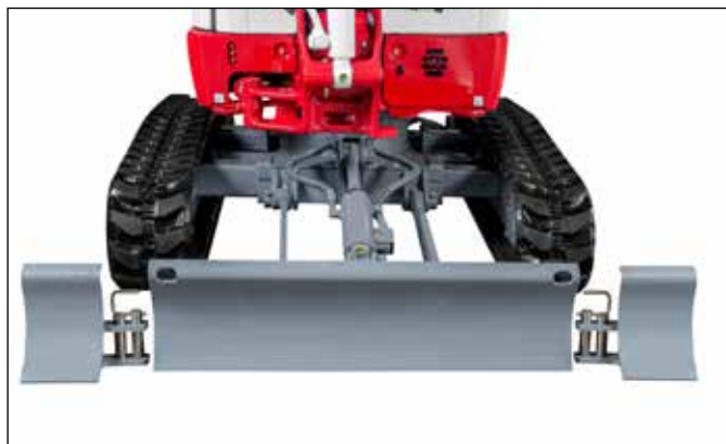
Pala dozer larga de acero antitorsión, ampliable manualmente.
