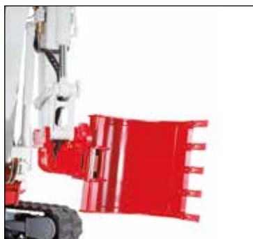
Power tilt con enganche rápido hidráulico, el cazo puede ser montado también al revés.
