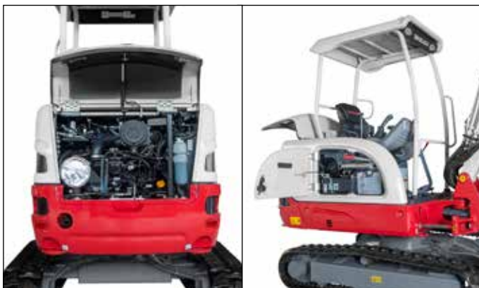
Amplias tapas de mantenimiento para un acceso cómodo a los componentes hidráulicos y al motor.
