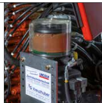
Engrase centralizado con dosificación controlada
