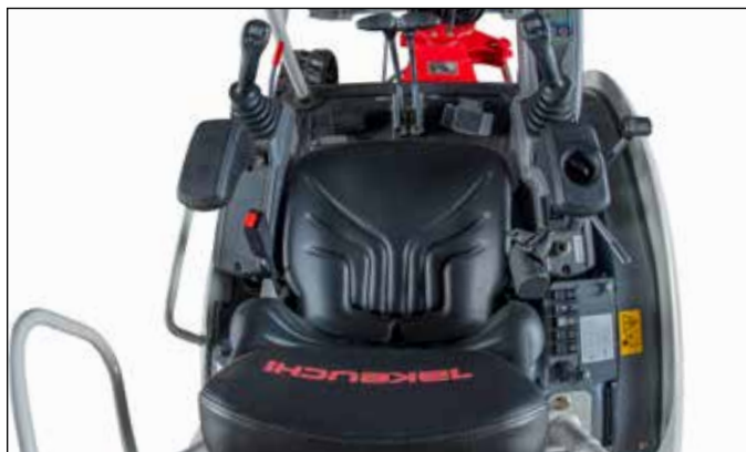
Control proporcional del sistema hidráulico auxiliar a través del joystick derecho e izquierdo.
