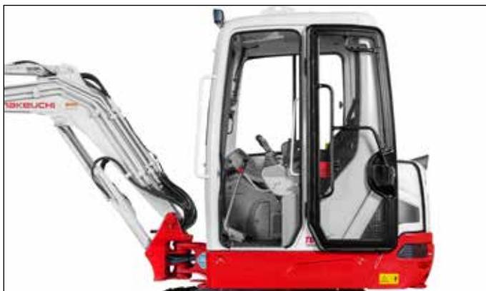
Cabina amplia insonorizada de baja vibración, con asiento de lujo para un trabajo sin cansancio (asiento resistente a la intemperie en versión Canopy).
