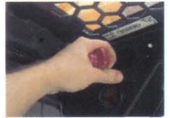
Seguridad en el trabajo- Brazo de alzamiento pueden ser inmovilizados desde el compartimiento del operador.
