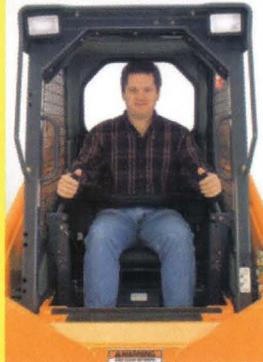
El asiento de suspensión se eleva sin mucho esfuerzo, dando acceso a las bombas hidrostáticas fácilmente durante mantenimiento de la unidad.
